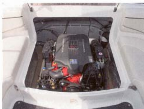
Motoren er sænket maksimalt ned i undervandskroget, for at bevare de lave linier.
