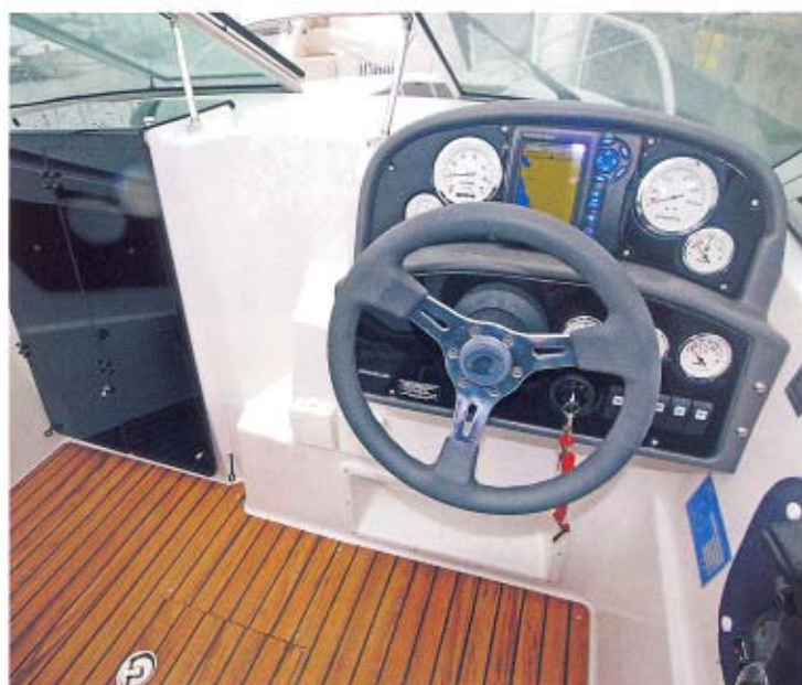
Instrumentpanelet er opgraderet med plads til en integreret kortskærm.
