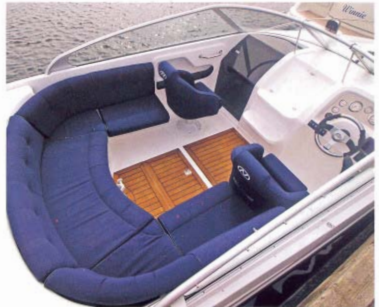
God siddekomfort. De forreste bænke kan fjernes for mere dørkplads. Agterbænken kan ændres til en solsen. Under dørk er stuverum.
