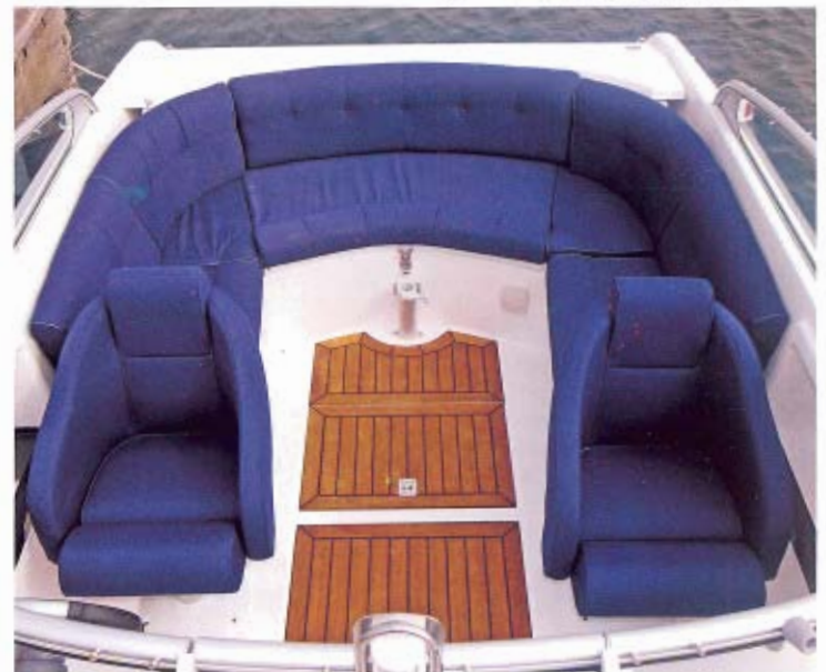
God siddekomfort. De forreste bænke kan fjernes for mere dørkplads. Agterbænken kan ændres til en solsen. Under dørk er stuverum.
