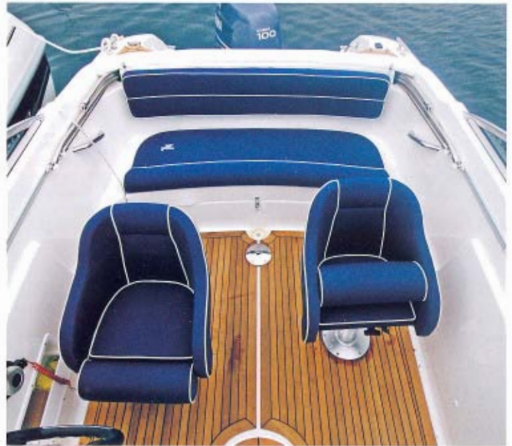
Cockpittet er enkelt med selvlænsende dørk. Kaleche i separat rum.
