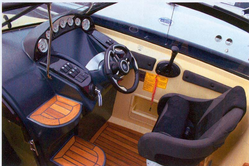
Meget god førerposition hvor der bl.a. er et todelt sæde, så man kan stå op og sejle. Bemærk det smarte design på instrumentpanelet, der har analoge instrumenter med hvid bund.
