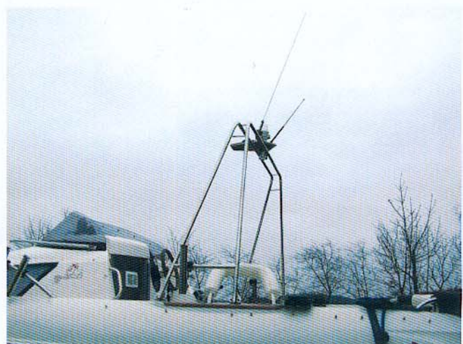
Da targa bøjlen er god bred i bunden, giver det god stabilitet.
